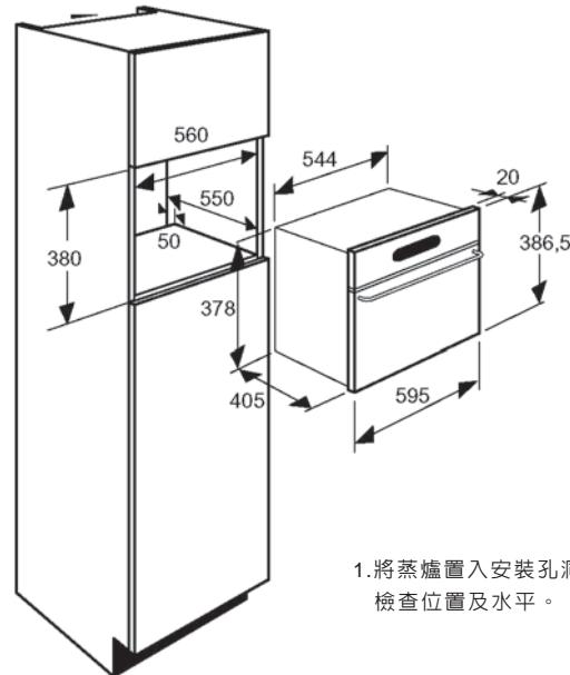
1. 將蒸爐置入安裝孔洞中。
