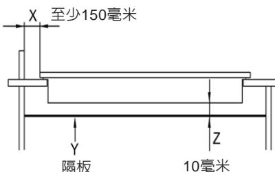
◎與本產品搭配使用的廚具組合之材質需為耐熱材質，且耐熱溫度需在85°C以上及厚度25至40毫米的作業面板上。
