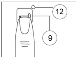
**⚠ 重要：**如果安全鎖功能啓動時關掉電陶爐，下次開啓電陶爐時，安全鎖啓動功能仍然存在。所以在你開啓一個烹煮區塊並設定電力前，必須先按安全鎖按鍵以解除這個功能。
