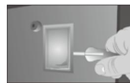
★使用工具將燈泡玻璃罩拆卸下來。
