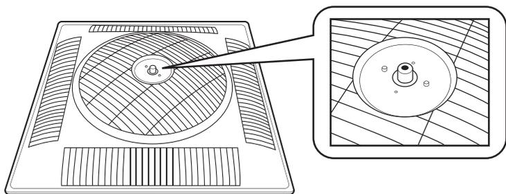
**2** 轉盤固定座鎖至接觸導風轉盤即可，不需過度緊鎖完成以上步驟後方可將循環善安裝於輕鋼架上。
