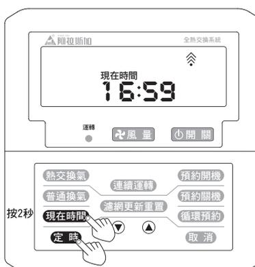
欲調整時間按住“現在時間”鍵2秒後使用▼▲鍵調整，先設定“時”確定後按下“定時”鍵。接著設定“分”確定後按下“現在時間”鍵即完成時間設定。
