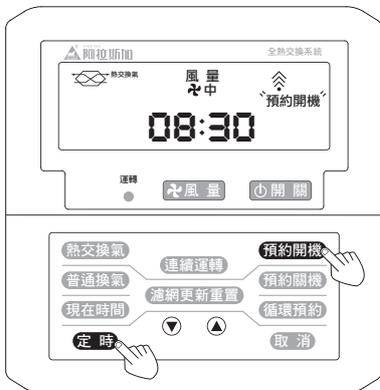
按 $\downarrow$ / $\uparrow$ 鍵設定開機時間。先設定“時”確定後按下“定時”鍵。接著設定“分”確定後按下“預約開機”鍵即完成預約開機設定。
