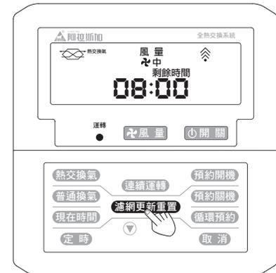
清潔過濾網完畢裝妥開機後按下“濾網更新重置”鍵2秒，濾網使用設定時間回復到3千小時。
