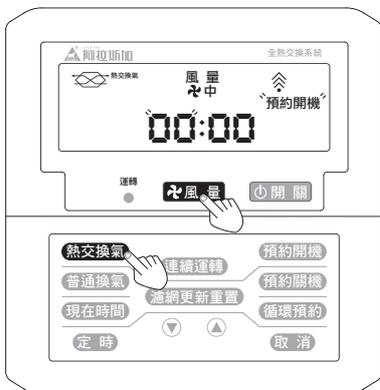
按下“風量”鍵設定風量。按下“熱交換氣”或“普通換氣”鍵設定換氣模式。（左圖為選擇熱交換氣）
